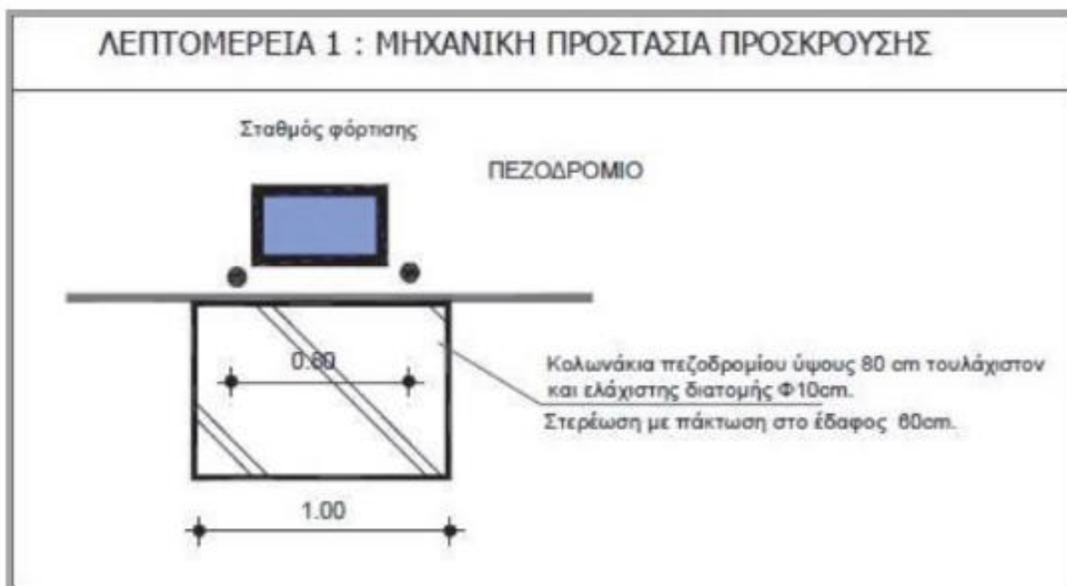
Εικόνα 8 Λεπτομέρεια μηχανικής προστασίας
